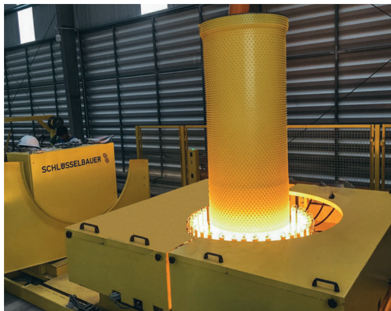
Термопластическая формовка футеровочного цилиндра – важный этап производства труб Perfect Pipe
