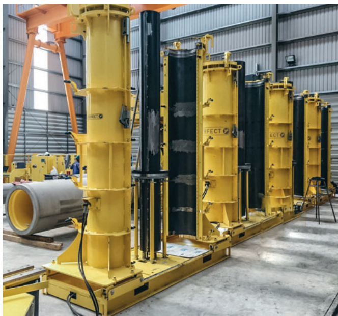
Простые в эксплуатации формы Perfect Forming Technology фирмы Schlüsselbauer на заводе компании Phnom Penh Precast в Камбодже
