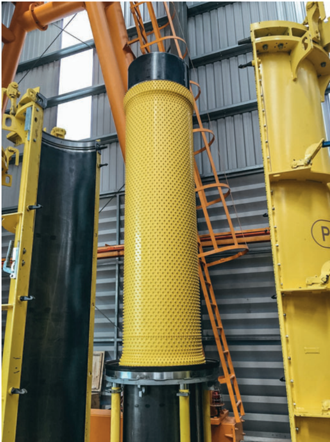
Футеровка Perfect Liner насаживается на сердечник с переменным сечением
